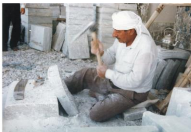
شكل رقم (17): الطريقة التقليدية في نحت (نقر) المرمر الموصلية والمستخدم في الحالة الدراسة (المصدر: الباحث).
